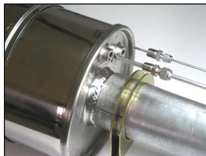
**Illustration 9** : installation de la conduite de pression (profondeur de 3 cm) et du capteur de température
