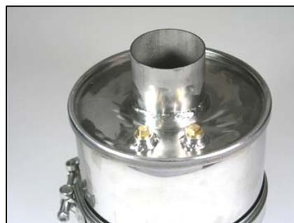
**Illustration 8** : raccords pour conduite de pression et capteur de température.
